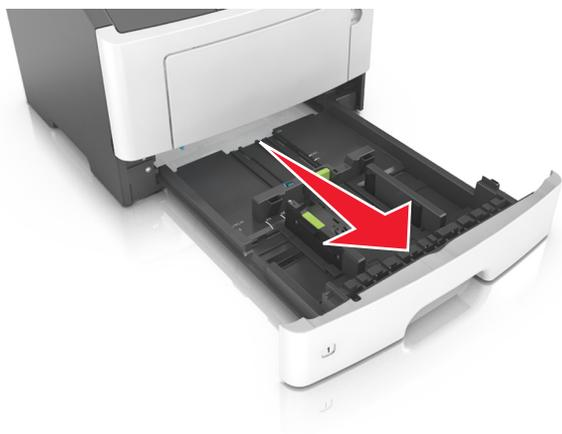
**2** Presione y deslice la lengüeta de la guía de anchura hasta colocarla en la posición correcta para el tamaño de papel que esté cargando.
