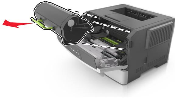
3 Levante la palanca verde y, a continuación, extraiga la unidad de imagen de la impresora.
