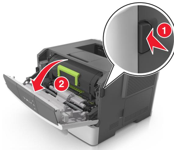
2 Extraiga el cartucho de tóner mediante la palanca.
