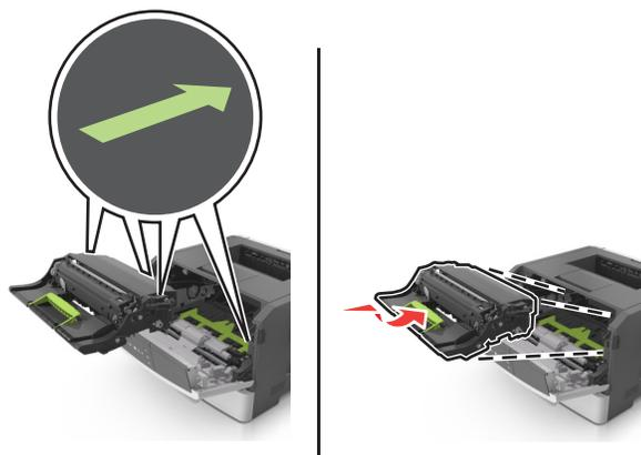
8 Insérez la cartouche de toner en alignant les rails latéraux de la cartouche avec celles situées sur les rails latéraux à l'intérieur de l'imprimante, puis insérez la cartouche dans l'imprimante.
