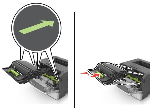
**8** Installare la cartuccia di toner allineando le guide laterali della cartuccia con le frecce sulle guide laterali all'interno della stampante, quindi inserire la cartuccia nella stampante.
