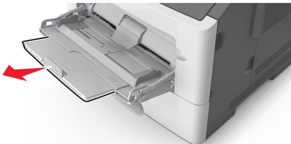
**b** Tirare l'estensione in modo che l'alimentatore multiuso sia completamente aperto.
