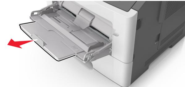
б Осторожно вытащите раскладную часть таким образом, чтобы полностью выдвинуть и открыть многоцелевое устройство подачи.
