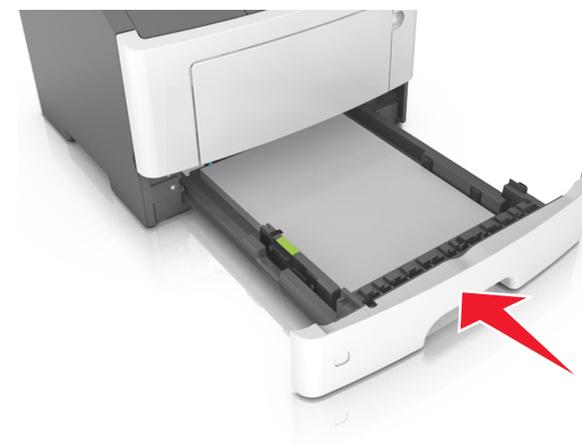
7 从打印机控制面板，在“纸张”菜单中设置纸张尺寸和纸张类型以匹配进纸匣中加载的纸张。
