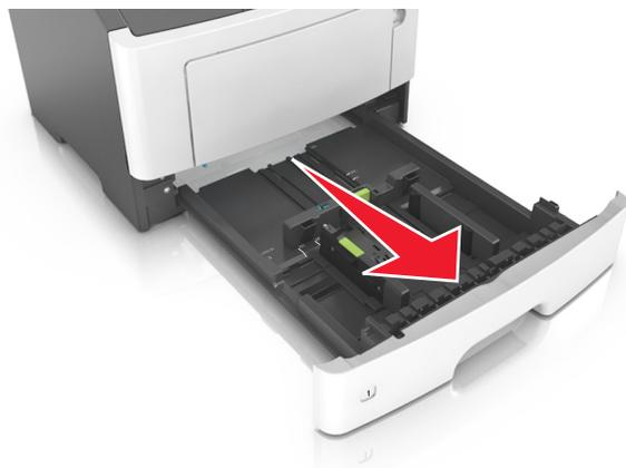
2 根據您所載入的紙張尺寸，捏住後移動寬度導引夾定位拉片，然後滑至正確的位置。
