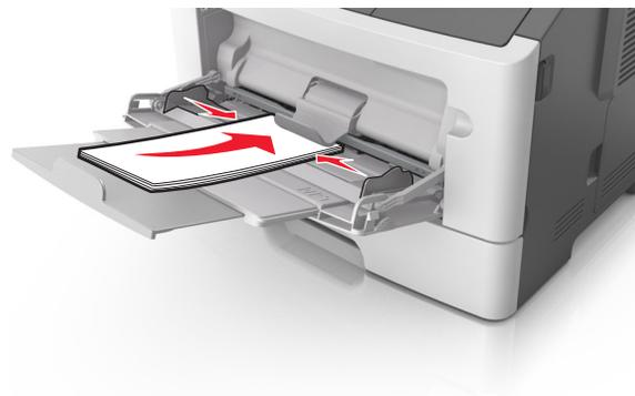
**Warnung - Mögliche Schäden:** Es dürfen keine Briefumschläge mit Briefmarken, Metallklammern, Haken, Fenstern, Fütterung oder selbstklebenden Aufklebern verwendet werden. Durch solche Briefumschläge kann der Drucker schwer beschädigt werden.
