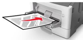
**請注意：**載入 A6 尺寸紙張時，請確認多用途送紙器的延伸組件必須輕輕靠放在紙張的邊緣，這麼做，最後幾張紙才能保持在原位。
