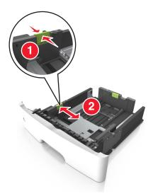
**3** Lösen Sie die Längenführung. Drücken Sie den Längenführungshebel zusammen und schieben Sie ihn an die richtige Position für das einzulegende Papierformat.
