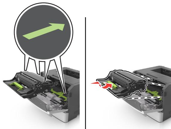
8 Führen Sie die Tonerkassette ein, indem Sie die seitlichen Führungen der Kassette auf die Pfeile an den seitlichen Führungen
