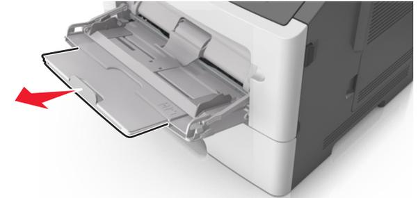
b Ziehen Sie die Verlängerung vorsichtig aus, bis die Universalzuführung vollständig herausgezogen und geöffnet ist.
