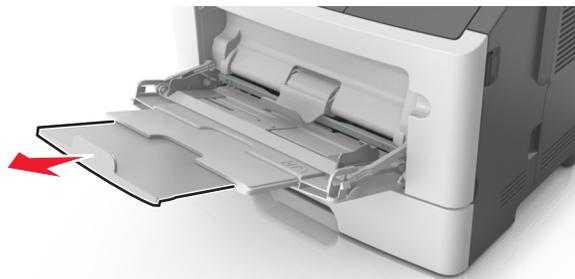
2 Aperte a guia na guia de largura esquerda e mova as guias para o tamanho do papel sendo colocado.
