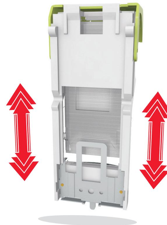
**Warnung - Mögliche Schäden:** Klopfen Sie mit der Kassette nicht auf eine harte Oberfläche. Die Kassette könnte dadurch beschädigt werden.
