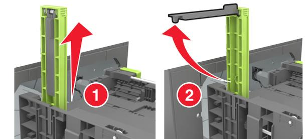
d Setzen Sie die A5-Längsführung in die vorgesehene Aufnahme ein.
