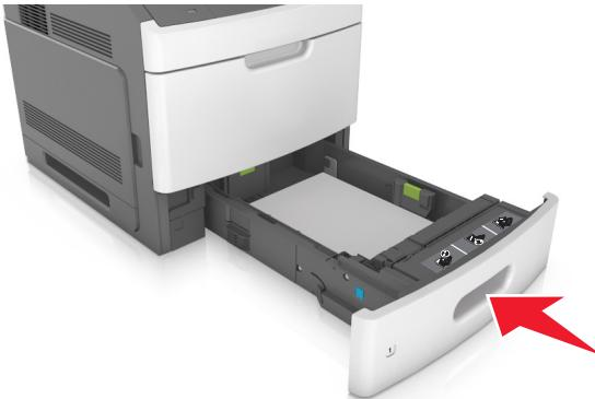
8 Din panoul de control al imprimantei, setați tipul și dimensiunea hârtiei din meniu Hârtie, pentru a corespunde cu hârtia încărcată în tavă.
