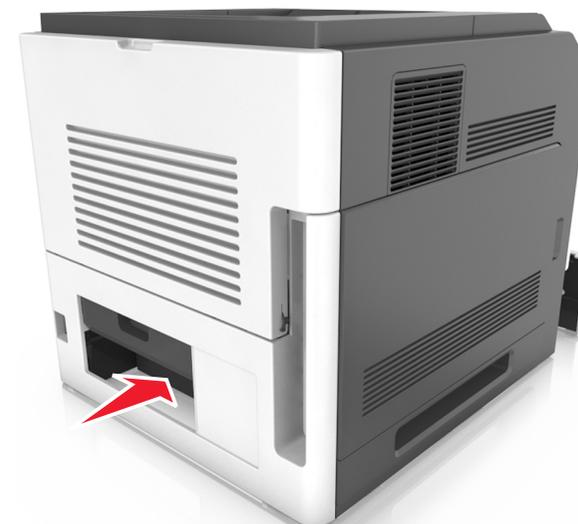
5 Нажмите на клапан задней части блока двусторонней печати, крепко возьмитесь за замятую бумагу и осторожно вытяните ее.
