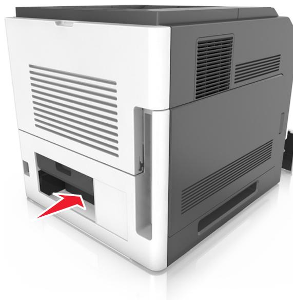
5 按下雙面列印裝置的後蓋，抓緊夾紙，然後輕輕將紙張拉出。
