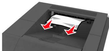
2 Um die Meldung zu löschen und den Druckvorgang fortzusetzen, wählen Sie die Option **Weiter**. > **OK** > **Beseitigen Sie den Papierstau, und drücken Sie auf OK** > **OK**.
