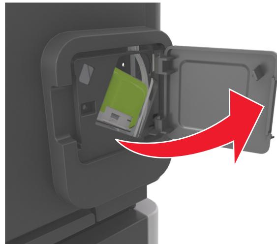
**3** Нажмите на фиксатор держателя кассеты со скобами и выньте держатель из принтера.
