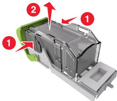
**4** Вставьте переднюю часть новой кассеты со скрепками в картридж, затем протолкните заднюю часть кассеты в картридж.
