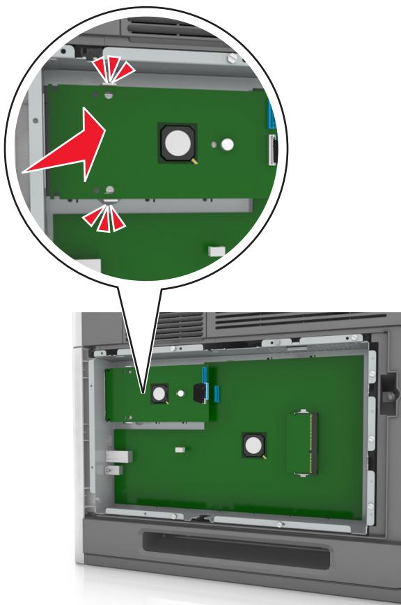
**8** Используйте прилагающийся винт для присоединения пластикового кронштейна к порту ISP.
