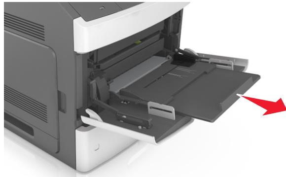
**Примечание.** Осторожно продвиньте раскладную часть таким образом, чтобы полностью выдвинуть и открыть многоцелевое устройство подачи.
