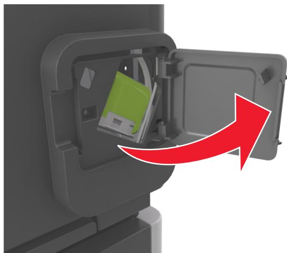
**2** Нажмите на фиксатор держателя кассеты со скобами и выньте держатель из брошюровщика.
