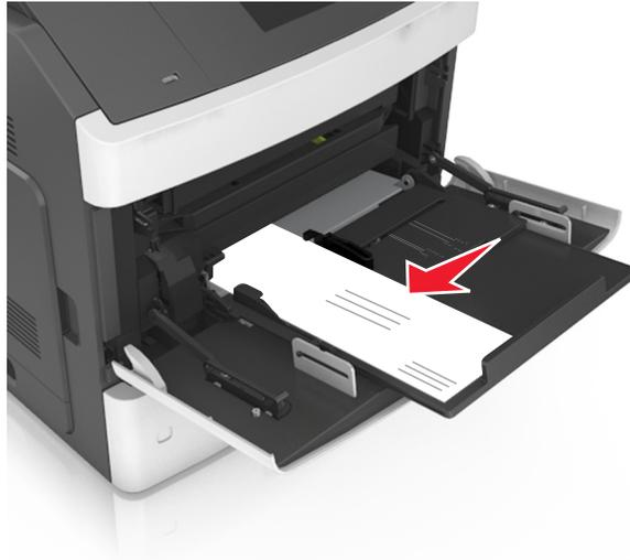
**Advertencia—Posibles daños:** No utilice nunca sobres con sellos, cierres, broches, ventanas, revestimientos oleosos o autoadhesivos. Este tipo de sobres puede dañar seriamente la impresora.
