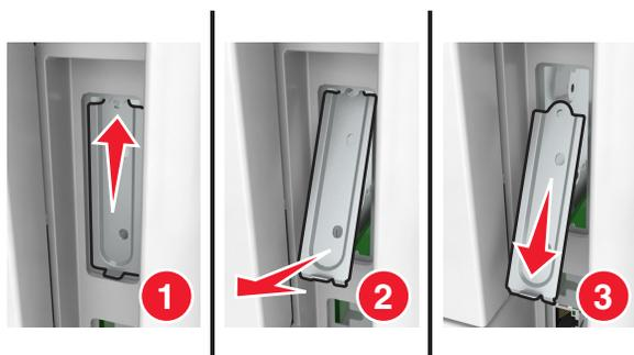
**5** Alignez les pattes situées sur le support en plastique avec les encoches situées sur le boîtier de la carte logique, puis appuyez le support en plastique contre le boîtier de la carte logique jusqu'à ce qu'il s'enclenche. Vérifiez que les câbles sont bien rangés sous le support en plastique.
