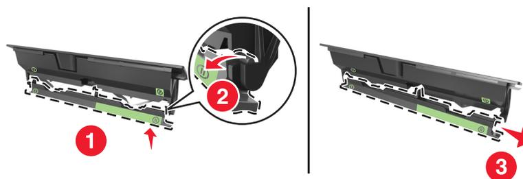
**4** Inserire il lato sinistro della linguetta del nuovo dispositivo di pulizia dell'unità di fusione attraverso lo slot sul lato sinistro della cornice del coperchio.
