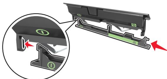
**5** Agganciare il lato destro del dispositivo di pulizia dell'unità di fusione al lato destro della cornice del coperchio.
