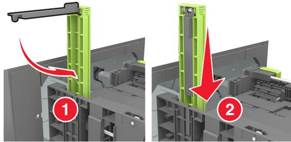
**d** Presione y deslice la guía izquierda hasta que alcance la posición correcta para el tamaño del papel que se está cargando, y espere a que haga *clac* en su lugar.
