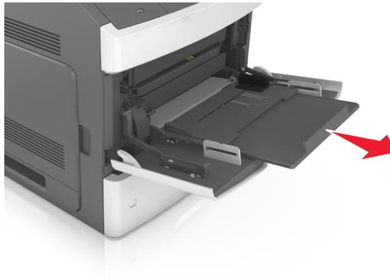
**Nota:** Mueva con cuidado la parte extensible para que el alimentador multiuso quede completamente extendido y abierto.
