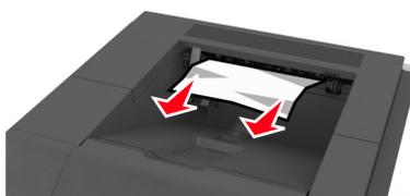
2 Para eliminar el mensaje y seguir imprimiendo, seleccione **Siguiente** > **OK** > **Elimine el atasco, pulse Aceptar** > **OK**.
