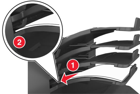
**Nota:** se la carta non si trova sotto il supporto, si verifica un inceppamento dovuto a un caricamento eccessivo del raccogliitore.
