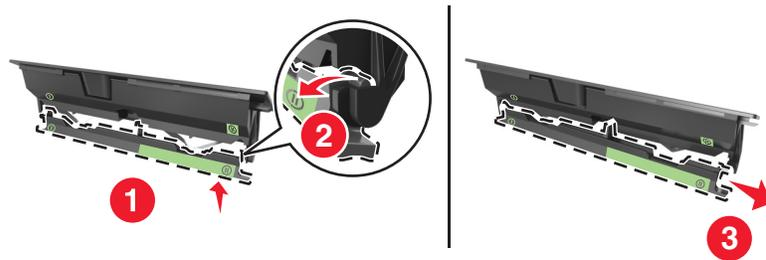
**4** Inserire il lato sinistro della linguetta del nuovo dispositivo di pulizia dell'unità di fusione attraverso lo slot sul lato sinistro della cornice del coperchio.
