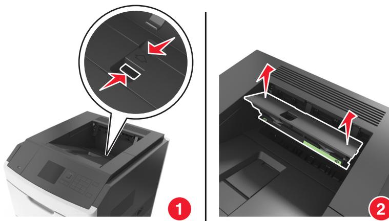
**3** Pressione a parte verde do limpador do fusor contra a tampa do limpador do fusor e solte o lado direito do limpador do quadro da tampa para remover o limpador do fusor.
