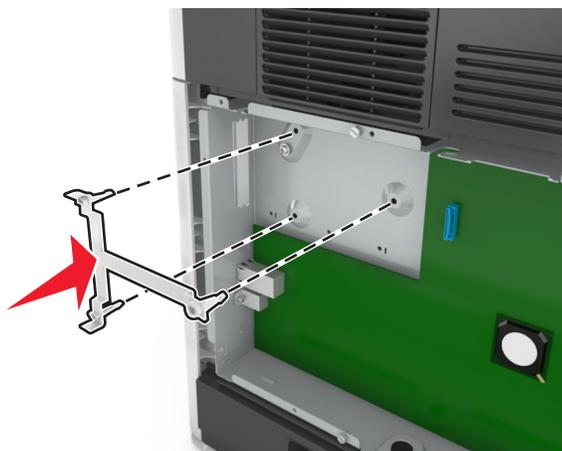
**Nota:** Certifique-se que o suporte de plástico esteja totalmente encaixado e que ele está encaixado firmemente na armação da placa do controlador.
