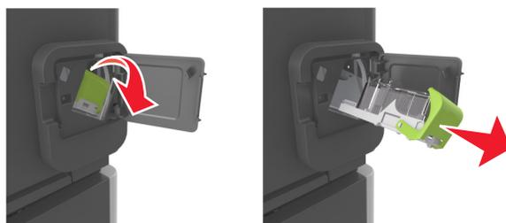
**4** Utilize a guia de metal para elevar a proteção de grampos e, em seguida, remova qualquer grampo solto.
