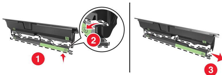
4 插入新的定影器刷片凸片的左边，穿过盖板框架左边的槽。
