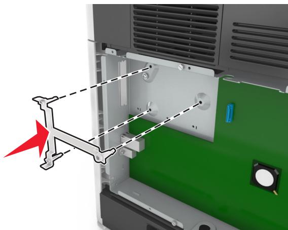
**注意：**确认塑料支架已经完全锁定，并且塑料支架被固定在控制器板框架上。
