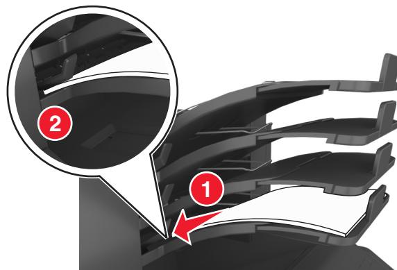
**注意：**如果纸张不在接纸架臂下面，那么会由于接纸架过满而造成卡纸。
