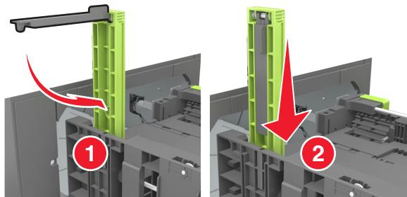
d 压住长度导片，并将它滑动到与您加载的纸张尺寸相符的正确位置上，直到它发出嗒一声，卡入到位。
