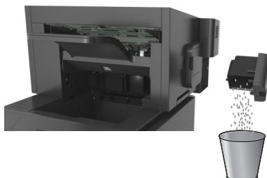
3 将已清空的打孔箱插回装订完成器中，直到它发出“喀”一声，卡入到位。
