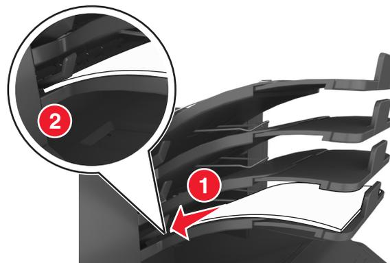
**Hinweis:** Wenn sich das Papier nicht unter dem Ablagearm befindet, tritt ein Papierstau aufgrund einer überfüllten Ablage auf.
