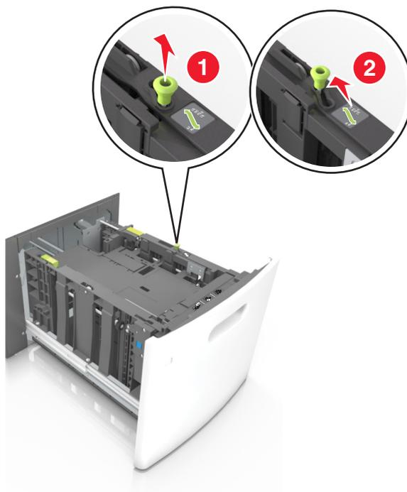
b A5 の長さガイドが取り付けられている場合は、取り外します。A5 の長さガイドが取り付けられていない場合は、手順 d に進みます。
