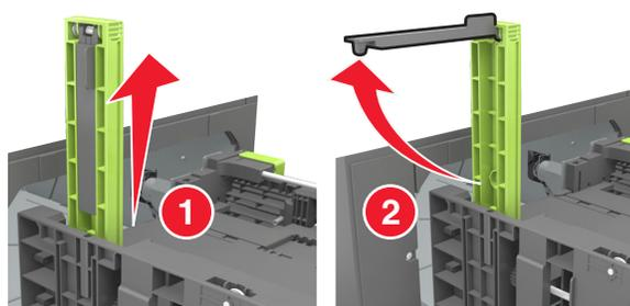
**d** A5 長さガイドを指定されたスロットに挿入します。
