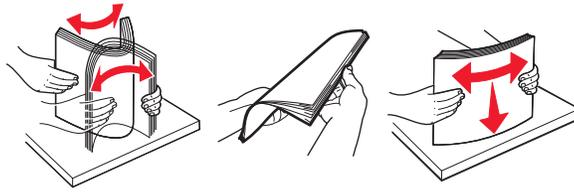
5 印刷面を下にして、用紙の束をセットします。
