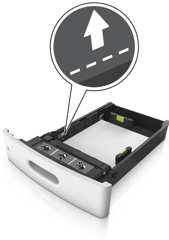
6 カスタムサイズまたはユニバーサルサイズの場合、用紙ガイドを調整し、紙の束の側面に軽く触れるようにして、長さガイドをロックします。
