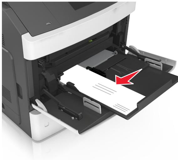
**Attention — Dommages potentiels :** n'utilisez jamais d'enveloppes avec timbre, agrafe, fermoir, fenêtre, revêtement intérieur couché ou bande autocollante. Ces enveloppes peuvent endommager sérieusement l'imprimante.
