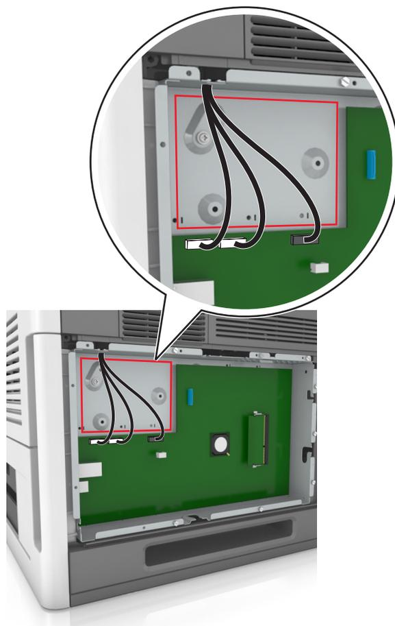
**Remarque** : Si un ISP en option est installé, le disque dur de l'imprimante doit être installé sur cet ISP.
