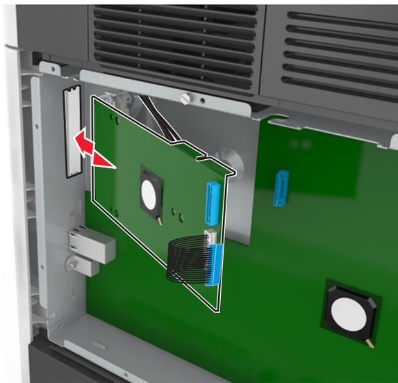
**Remarque :** Inclinez le port ISP au-dessus du support en plastique de sorte que les tiges des connecteurs placés en saillie traversent l'ouverture ISP installée sur la carte logique.
