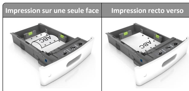
**Remarque :** Un bourrage papier peut se produire si les perforations sur le bord long du papier se trouvent du côté gauche du bac.
