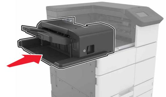
**[x]-Papierstau, öffnen Sie Klappe H und drehen Sie Griff H6 im Uhrzeigersinn. Lassen Sie das Papier in der Ablage. [426.xx428.xx]**
