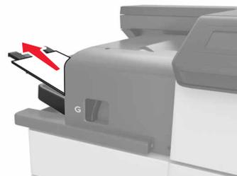
2 Pressione a trava no encadernador e, em seguida, deslize o encadernador para a esquerda.
