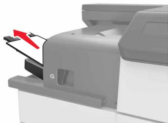
2 Нажмите на фиксатор на брошюровщике со скобами, затем сдвиньте брошюровщик влево.
