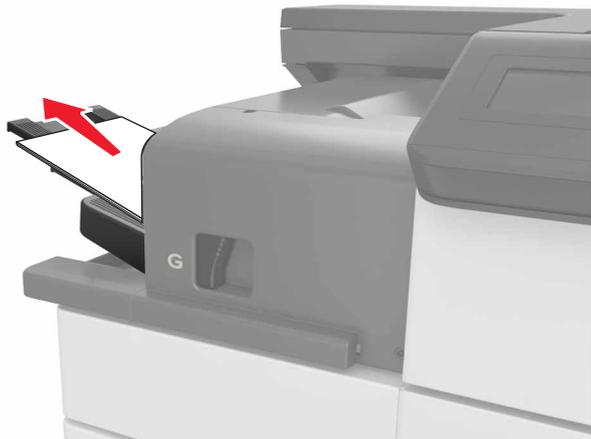
2 Нажмите на фиксатор и сдвиньте брошюровщик со скобами влево, затем уберите замятую бумагу.
