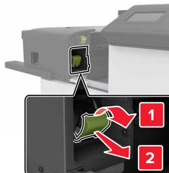
4 С помощью металлической скрепки поднимите ограничитель прошивочных скоб и удалите все выпавшие скрепки.
