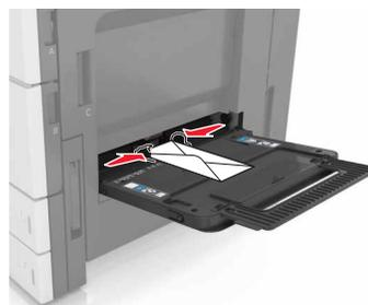
**警告—潛在損害：**切勿使用有郵票、拴扣、勾環、窗格、覆膜襯裡或自黏式的信封。這類信封可能會嚴重損壞印表機。
