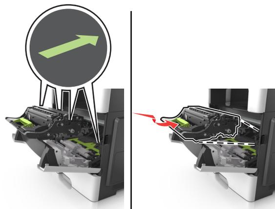
8 Installare la cartuccia di toner allineando le guide laterali della cartuccia con le frecce sulle guide laterali all'interno della stampante, quindi inserire la cartuccia nella stampante.
