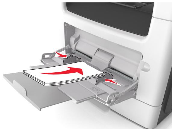
**Advertencia—Posibles daños:** No utilice nunca sobres con sellos, cierres, broches, ventanas, revestimientos oleosos o autoadhesivos. Este tipo de sobres pueden causar un grave deterioro en la impresora.
