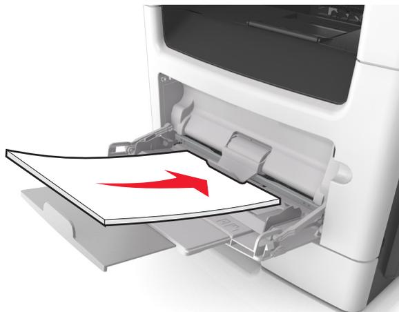
**注意：**确认纸张导片轻轻地靠着纸张的边缘。
