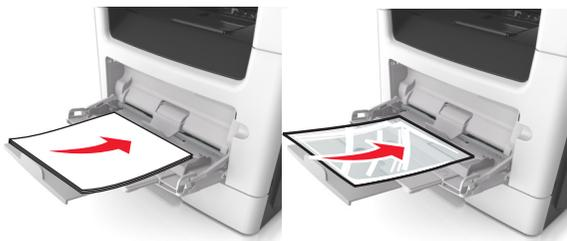
**注意：**当加载 A6 尺寸的纸张时，请确认多功能进纸器扩展板轻轻地靠着纸张的边缘，以使最后几张纸留在原位。
