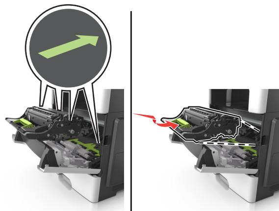
8 Installare la cartuccia di toner allineando le guide laterali della cartuccia con le frecce sulle guide laterali all'interno della stampante, quindi inserire la cartuccia nella stampante.
