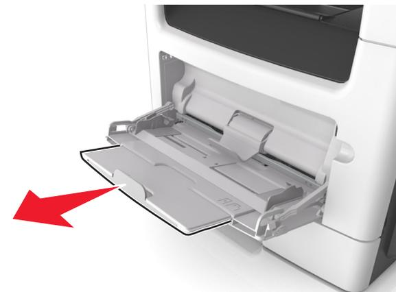
b Tirare l'estensione in modo che l'alimentatore multiuso sia completamente aperto.
