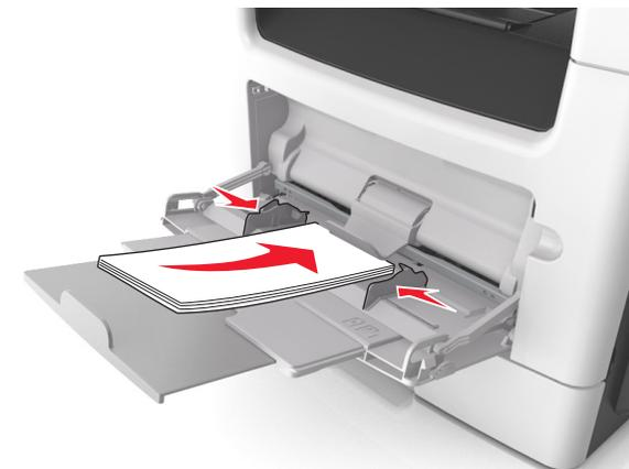
**ПРЕДУПРЕЖДЕНИЕ. Возможность повреждения:** Не используйте конверты со штампами, зажимами, застежками, окнами, подкладкой и самоклеющимися деталями. Использование таких конвертов может привести к серьезному повреждению принтера.
