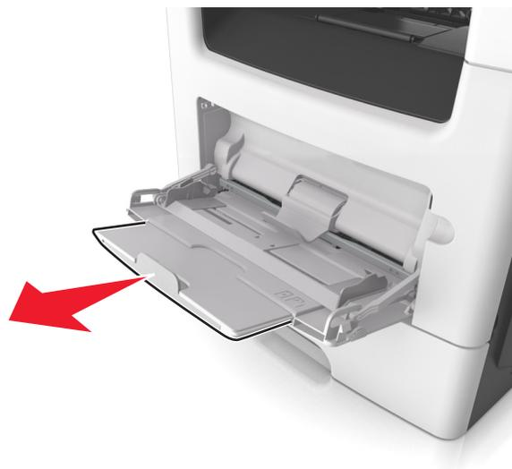
b Ziehen Sie die Verlängerung vorsichtig aus, bis die Universalzuführung vollständig herausgezogen und geöffnet ist.
