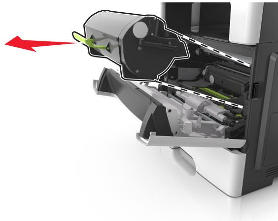
3 Heben Sie den grünen Hebel an und ziehen Sie dann die Belichtungseinheit aus dem Drucker heraus.
