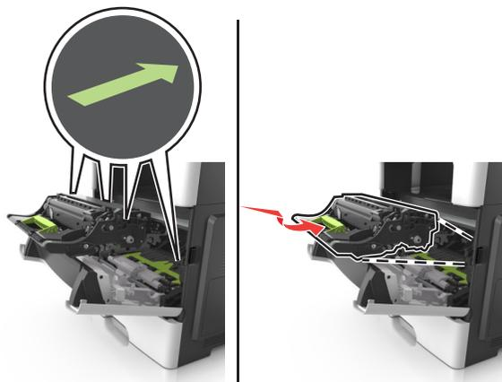
8 Führen Sie die Tonerkassette ein, indem Sie die seitlichen Führungen der Kassette auf die Pfeile an den seitlichen Führungen im Drucker ausrichten, und setzen Sie die Kassette dann in den Drucker ein.
