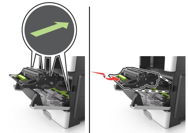
**8** 将碳粉盒的侧导轨与打印机内部侧导轨上的箭头对齐，然后将碳粉盒插入打印机中。
