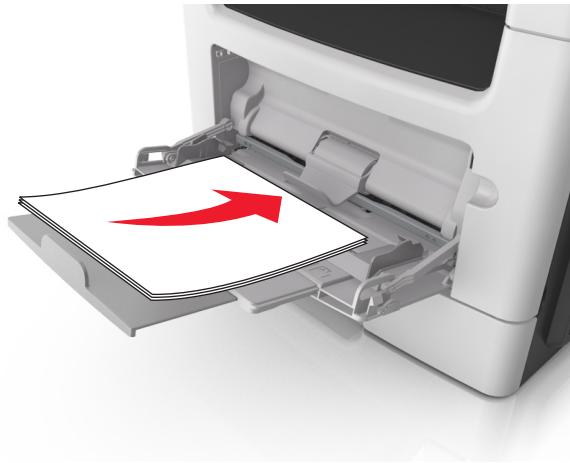
**注意：**确认纸张导片轻轻地靠着纸张的边缘。
