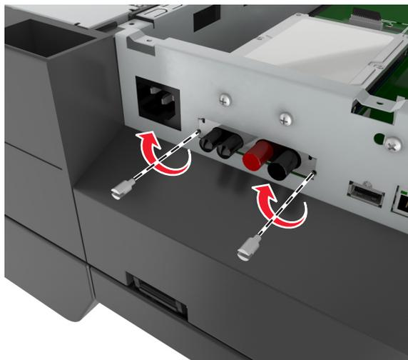
**Nota:** Los tornillos se pasan por el orificio libre de la carcasa y se fijan a la abrazadera del ISP.
