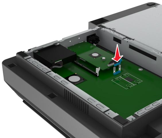
**8** Retire los tornillos de ajuste manual que fijan la abrazadera de montaje del disco duro al propio disco duro. A continuación, retire la abrazadera.
