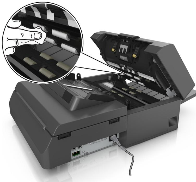
5 Con el paño, limpie los rodillos de la parte inferior del alimentador automático hasta eliminar todos los residuos.
