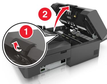
4 Con el paño, limpie los rodillos de la parte superior del alimentador automático hasta eliminar todos los residuos.
