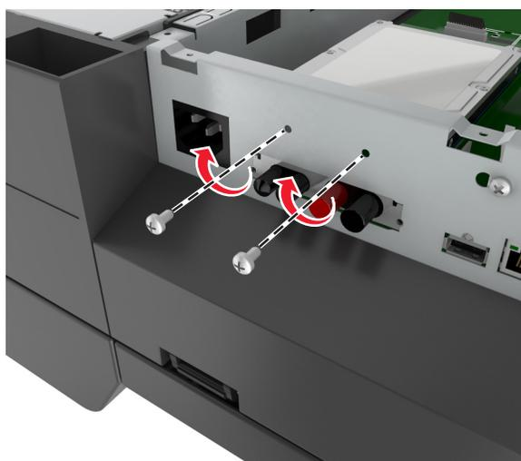
**Nota:** Utilizzare le viti rimosse al [passo 5](#) per fissare il disco fisso alla staffa.
