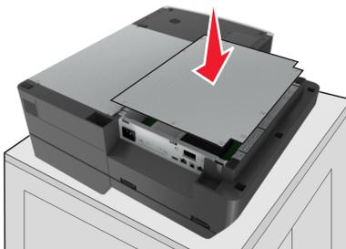
**9** Inserire tutte le viti per fissare il coperchio della scheda di sistema.
