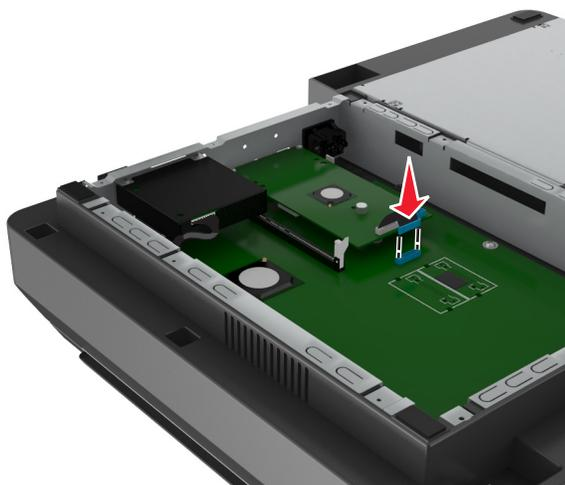
**8** Rimuovere la vite che fissa la staffa di montaggio del disco fisso al disco fisso, quindi rimuovere la staffa.
