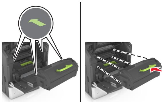
**Avvertenza — Danno potenziale:** Quando si sostituisce una cartuccia di toner evitare di esporre l'unità immagini alla luce diretta per un periodo di tempo prolungato. L'eccessiva esposizione alla luce può compromettere la qualità di stampa.
