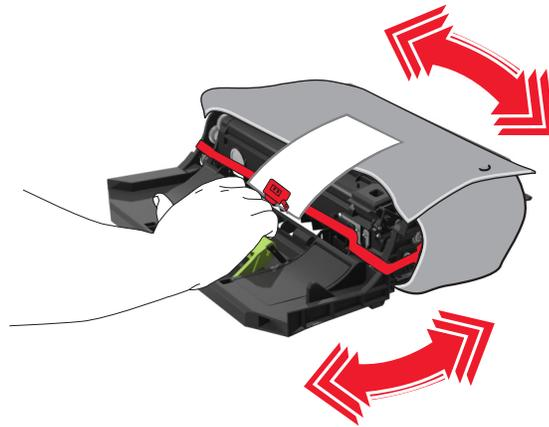
6 Inserire l'unità immagini nella stampante allineando le frecce sui binari laterali dell'unità immagini alle frecce sui binari laterali all'interno della stampante.
