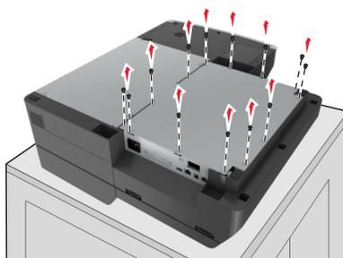
6 Снимите защитную крышку системной платы.
