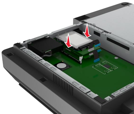
**11** Вставьте штекер интерфейсного кабеля жесткого диска в разъем порта ISP.
