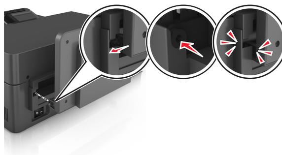
**б** Нажмите на лоток, чтобы закрепить его на передней петле.
