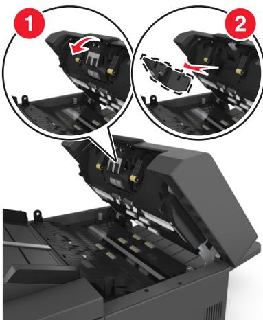
3 Распакуйте новую подкладку разделителя, затем установите ее в сканер.
