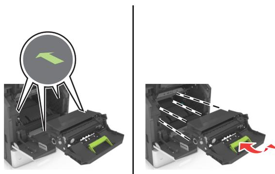
7 Установите картридж с тонером, совместив стрелки на боковых направляющих картриджа со стрелками на боковых направляющих внутри принтера, а потом вставьте картридж в принтер.
