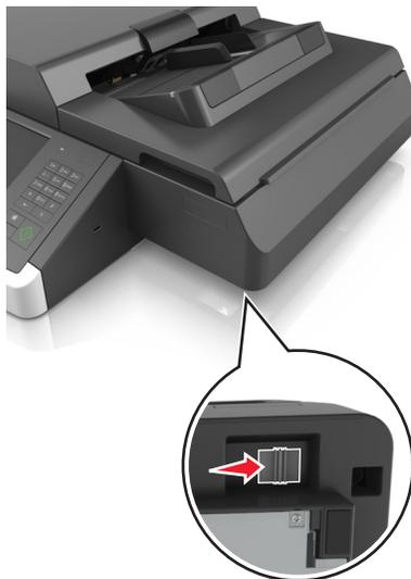
2 Закрепите крышку сканера лентой.
