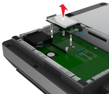
**4** Снимите металлическую крышку с отверстия порта ISP.
