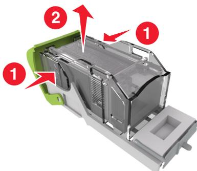
4 Вставьте переднюю часть новой кассеты со скрепками с картридж, затем протолкните заднюю часть кассеты в картридж.
