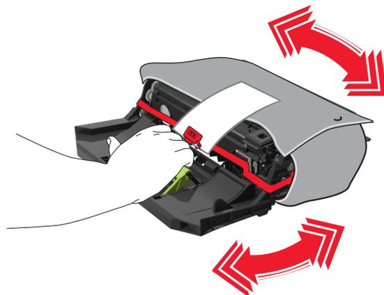
6 Установите блок формирования изображения, совместив стрелки на боковых направляющих формирователя со стрелками на боковых направляющих внутри принтера, а потом вставьте формирователь в принтер.
