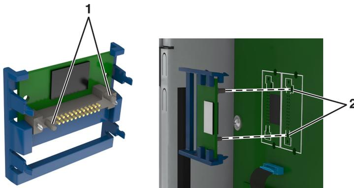
5 С усилием вставьте плату в разъем, отображенный на иллюстрации.
