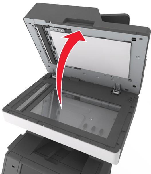
6 Wenn Papierstau an der Klappe an der Unterseite der ADZ oder in der ADZ-Ablage vorliegt, öffnen Sie die Klappe an der Unterseite des ADZ, und greifen Sie das gestaute Papier auf beiden Seiten.
