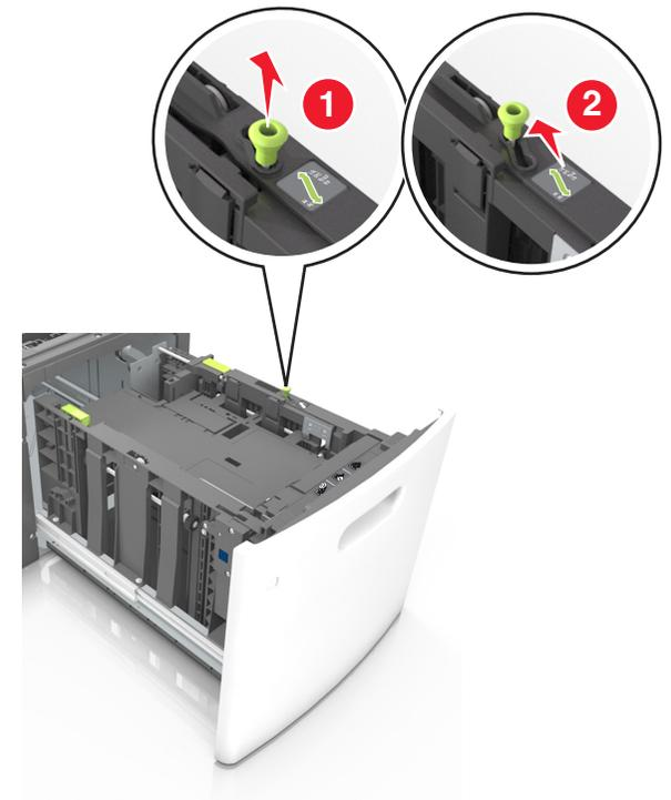
**b** Wenn die A5-Längenführung immer noch an der Längenführung befestigt ist, entfernen Sie sie. Wenn die A5-Längenführung nicht befestigt ist, fahren Sie mit Schritt (d) fort.
