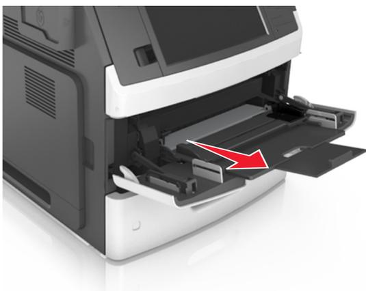
**Nota:** Mueva con cuidado la parte extensible para que el alimentador multiuso quede completamente extendido y abierto.
