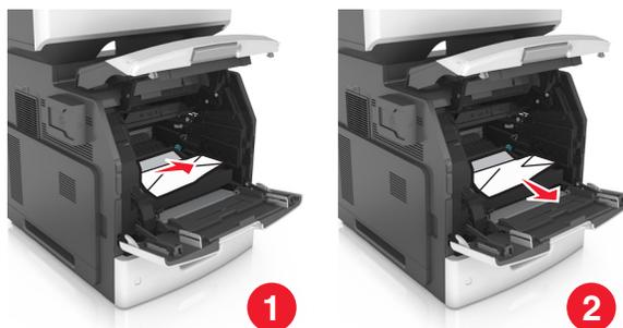
**ПРЕДУПРЕЖДЕНИЕ. Возможность повреждения:** Замятая бумага может быть покрыта тонером, который может оставлять пятна на одежде и коже.
