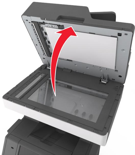
6 如果纸张卡在底部 ADF 盖门或 ADF 输出接纸架中，请打开底部 ADF 盖门，然后用力抓住被卡纸张的两边。
