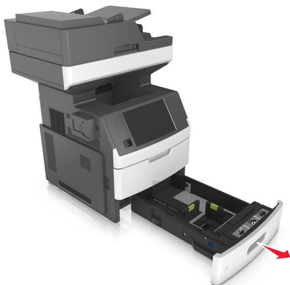
2 压住宽度导片，并将它滑动到您加载的纸张尺寸相符的正确位置上，直到它发出**咔嚓**一声，卡入到位。
