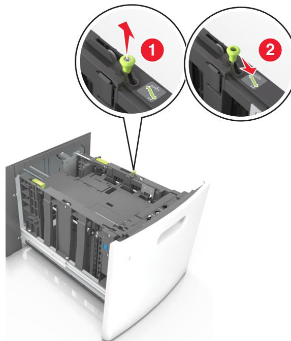
b 捏住長度導引夾，將它滑到 A5 適用的位置，直到它發出喀嚓一聲，卡入定位。
