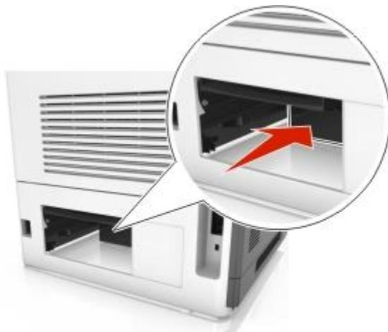
5. Zatlačte nadol zadnú klapku duplexnej jednotky, pevne uchopte zaseknutý papier a opatrne ho vytiahnite von.
