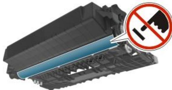
6. Založte zobrazovaciu jednotku do tlačiarne zarovnaním šípkov na bočných koľajničkách zobrazovacej jednotky so šípkami na bočných koľajničkách vo vnútri tlačiarne.
