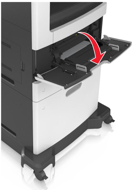
2 Utilizando el asidor, tire de la parte extensible del alimentador multiuso.
