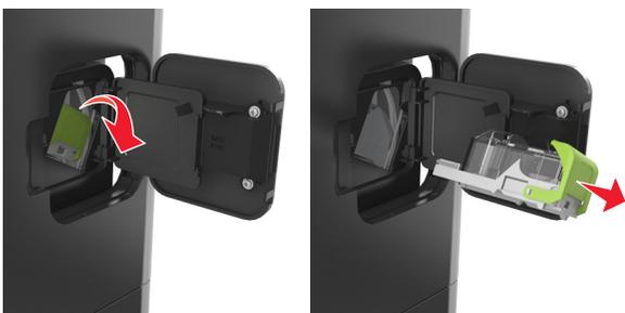
4 Utilice la lengüeta metálica para levantar la protección de grapas y extraiga las grapas sueltas que queden.
