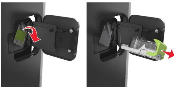
**4** С помощью металлической скрепки поднимите ограничитель прошивочных скоб и удалите все выпавшие скрепки.
