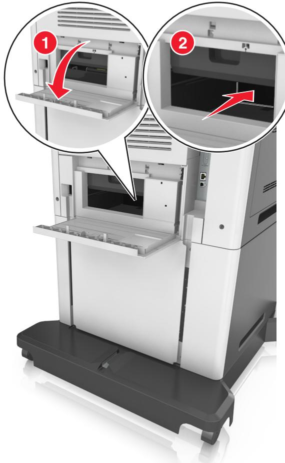
5 Нажмите на клапан задней части блока двусторонней печати, крепко взымитесь за замятую бумагу и осторожно вытяните ее.
